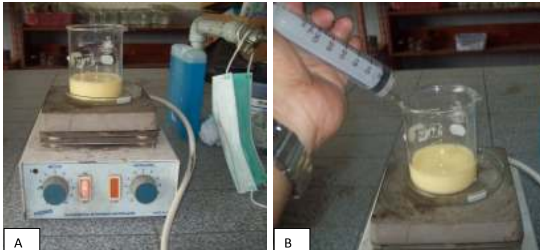
Gambar 3. Mesin stirrer dikombinasi dengan hotplate (A). Pengatur kecepatan adukan (putaran batang magnet) adalah tombol hijau di sebelah kiri, tombol kanan untuk pengatur suhu. Pada praktikum ini pengatur suhu tidak dihidupkan, plate dibiarkan dingin. Gambar (B) menunjukkan cara pemberian Reagen A ke sediaan yolk.
