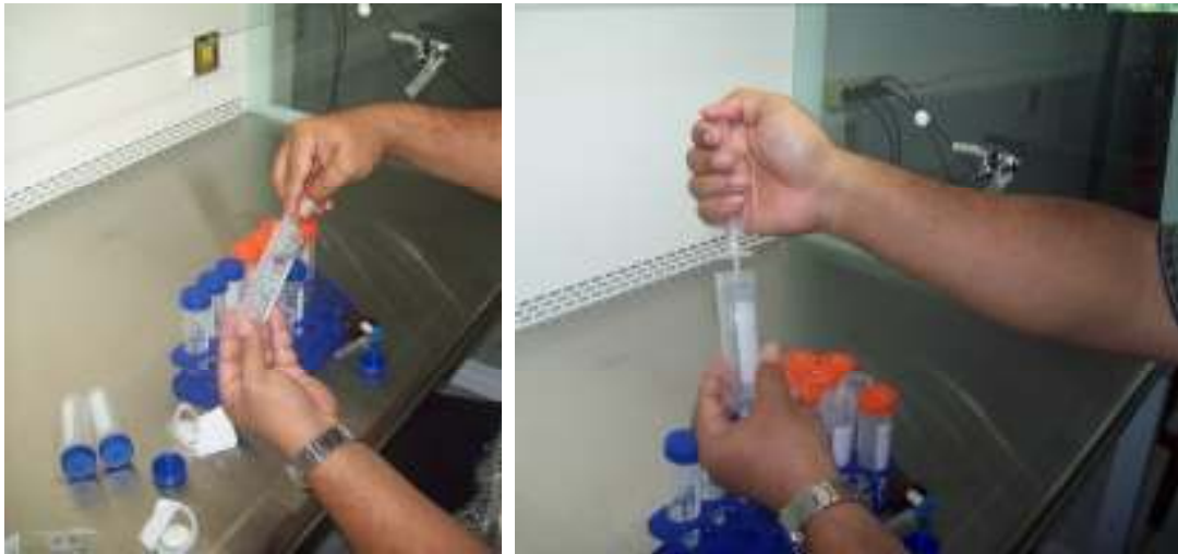
Gambar 7. Cara sterilisasi menggunakan filter disposable dengan bantuan spuit injeksi (Syringe sterilization)
