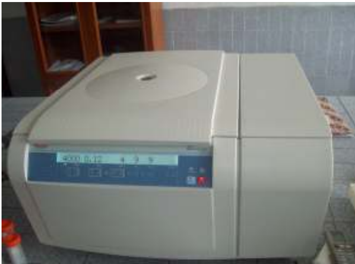
Gambar 4. Mesin sentrifus dingin. Mesin sentrifus bekerja memisahkan komponen suatu larutan dengan cara memutarnya dengan kecepatan tinggi. Mesin ini dapat diatur kecepatan, suhu, dan waktu
